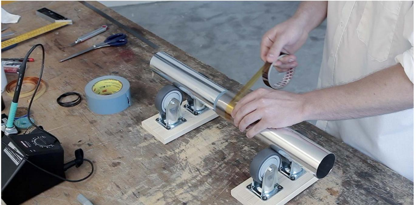
Fig. 33: Apply Kapton tape
