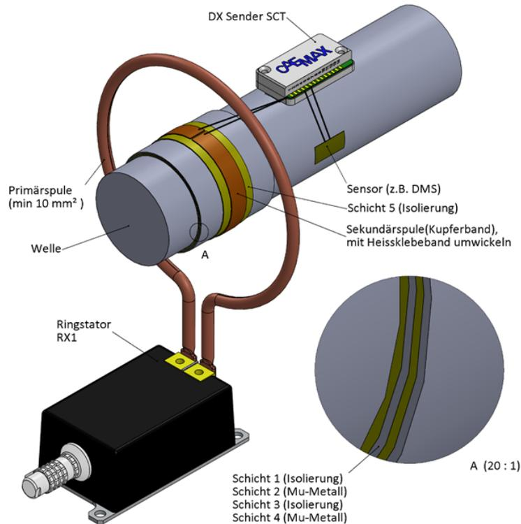
Fig. 44: Applikation Ringstator
