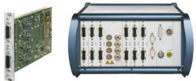
Abbildung 8: High Resolution Encoder-Interface (HRENC-4) und Universalmessgerät imc CRONOS-PL 4
